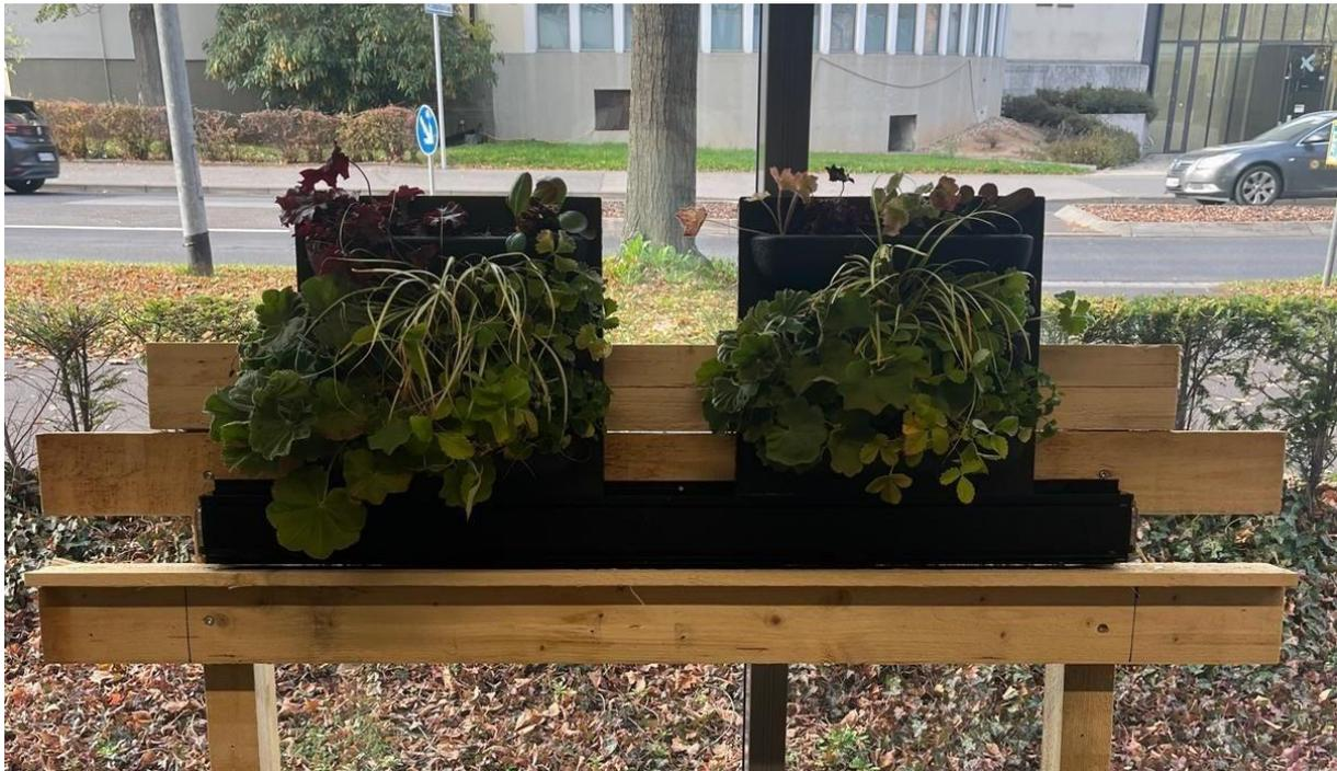
Erster Versuchsaufbau im Labor am Campus Konrad Geiger der THWS; Fassadenpanels bestückt mit unterschiedlichen Pflanzen. Die Panels werden mit verschiedenen Sensoren zur automatisierten Bewässerung und Umweltüberwachung ausgestattet. Foto: Daniel Drobizow
